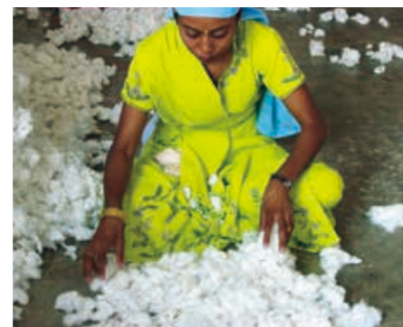
ジン工場 (種の除去) 買付けた綿はジン工場へ運ばれ手作業でゴミなどを丁寧に分けた後、機械で種を除去します。
