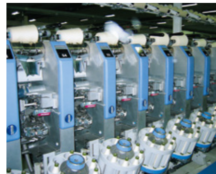
紡績工場（タオル専用糸） 最上級AAAグレードから厳選された綿は清潔な紡績工場です。タオルに適した甘燃り糸に仕上げられます。
